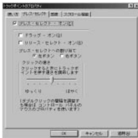
「プレス・セレクト - オン」のボックスにチェック・マークを付けてプレス・セレクトを使用可能にすると、トラックポイントのスティックを、左クリック・ボタンまたは右クリック・ボタンと同じように機能させることができます。
