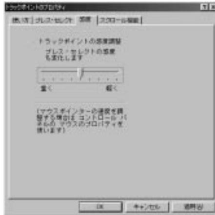
この機能は、マウス・ポインターとプレス・セレクトの両方の感度を同時に調節します。「重く」の方にスライドさせると、マウス・ポインターの動きは鈍くなり、プレス・セレクトは、より強く押さなければ入力できなくなります。また、「軽く」の方にスライドさせると、マウス・ポインターの動きは軽くなり、プレス・セレクトは弱く押すだけで入力できるようになります。
