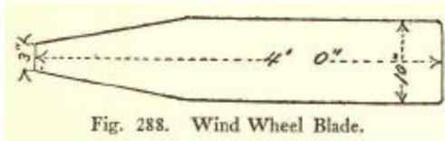
Fig. 288. Wind Wheel Blade.
