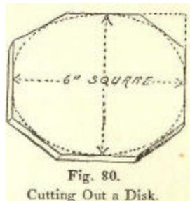
Fig. 80. Cutting Out a Disk.
