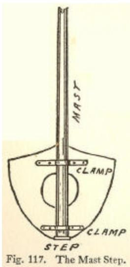
Fig. 117. The Mast Step.
