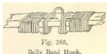
Fig. 240. Belly Band Hook.
